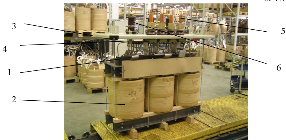
Рис. 2.1 Активная часть в сборе. 1 – магнитопровод; 2 – блок обмоток ВН – НН; 3 – крышка бака; 4 – переключатель; 5 – ввод НН; 6 – ввод ВН.
